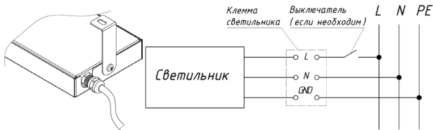
Рисунок 5. Схема подключения светильника.
